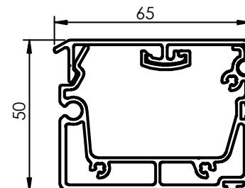
Sul lato anteriore del profilo inferiore può essere anche montata una guarnizione in gomma o spazzolino. In alcune circostanze, questi componenti possono essere montati anche sul lato basso del profilo
