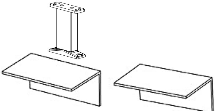
Nota: Se viene utilizzato il rullo intermedio, la Veranda si fissa nei punti di fissaggio in alluminio più alti – 120 mm.
