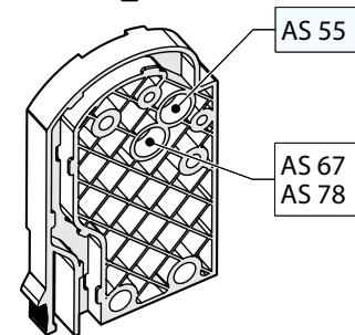
Sulla parte inferiore ci sono due fori per attaccare l'arresto della piastra di fondazione alle sponde.
