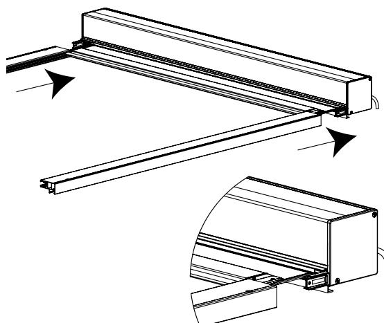
**Passo 2: Inserimento delle liste di guida ai perni della consolle dalla parte inferiore del box**
