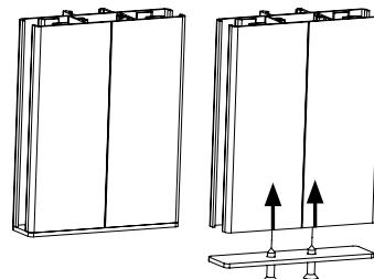
Con l'arresto terminale di plastica nera o con la lamiera di alluminio terminale sul lato inferiore per l'arresto della lista inferiore; spessore 2 mm.
