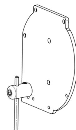
Avvitare le consolle alla parete con aiuto di viti e pezzi adeguati per il tipo della costruzione, alla quale si montano (costruzione di metallo, cemento, muratura, ecc.). Se necessario, ingrandire la rientranza della consolle dalla parete con aiuto di rondelle. Il cavetto va sempre disteso e tenuto affinché non si contorcia.
