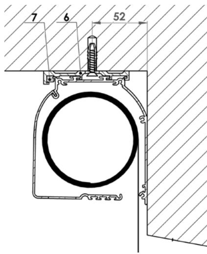
Montare le consolle (6) con aiuto di viti e pezzi adeguati per il tipo della costruzione alla quale si montano (costruzione di metallo, il telaio della finestra, la parete o un altro materiale) Nei casi in cui si usano tre o più pezzi di consolle, assicurare che le consolle siano perfettamente bilanciate  $\pm 1\text{mm}$ ; ciò si può verificare, muovendo la cassetta lungo gli incavi prima di serrare le viti di fissaggio.
