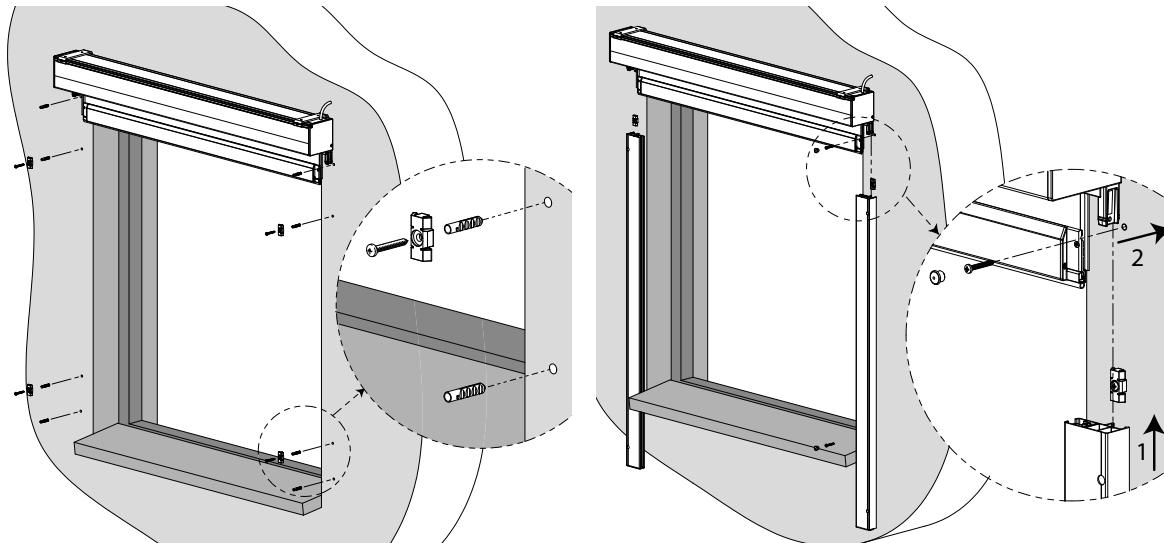
**METODO 2: Sistemazione del set completo del box e delle liste di guida nel vano della finestra o sopra ad esso e fissaggio con le viti.**
