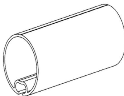
Materiale: alluminio estruso per tubi Ø 55 ed acciaio zincato per tubi ø 85 mm a ø 100 mm.
