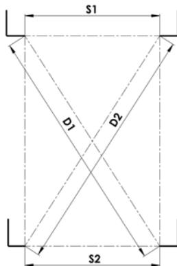
Finito il montaggio, verificare se le liste di guida siano parallele e rettangolari. Ciò è possibile, misurando le due distanze "S1" e "S2" o delle diagonali „D1“ e „D2“. Le dimensioni devono essere uguali  $\pm 2\text{mm}$ . Il corretto collocamento delle liste di guida è necessario, altrimenti può essere intaccata la funzione della tende a rullo. Nel caso del montaggio frontale della lista di guida, vengono consegnati i tappi autoadesivi per coprire i fori delle viti di fissaggio.
