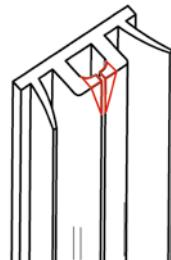
Le liste di guida ZIP si compongono di tre parti: due rotaie in alluminio e una rotaia interna in plastica nella quale si muove ZIP.
