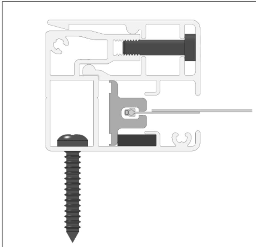
3.a Sezione guida A840-1 dopo il montaggio laterale
