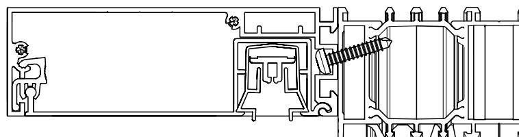
**Lista di guida 1040 = lista di guida 1120 montata sulla superficie**
