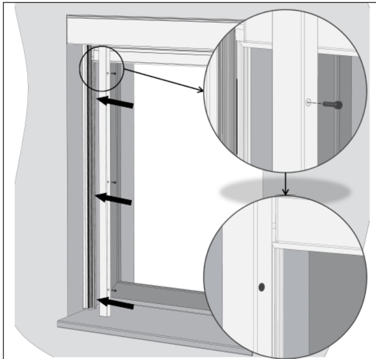
3.a Sezione guida A840-1 dopo il montaggio frontale
