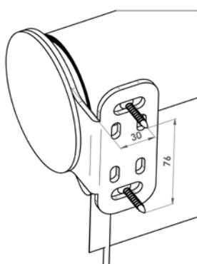
Il montaggio della tende a rullo screen al soffitto va iniziato con la misurazione della posizione dei fori di attacco delle consolle portanti.
