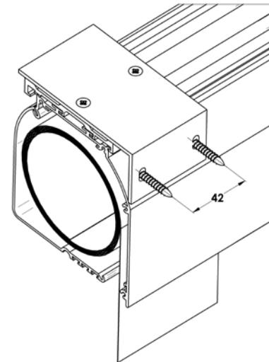
Montare le consolle con aiuto delle viti e dei pezzi adeguati per il tipo della costruzione alla quale si montano (costruzione di metallo, telaio della finestra o un altro materiale)
