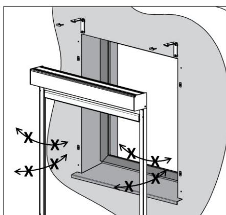
**Fase 5: Fissaggio del box alle staffe a parete/soffitto e avvitatura delle guide**
