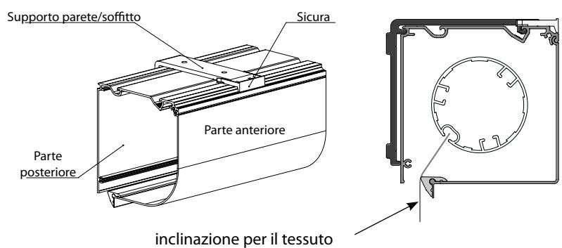
**Materiale:** alluminio estruso con verniciatura in polvere
