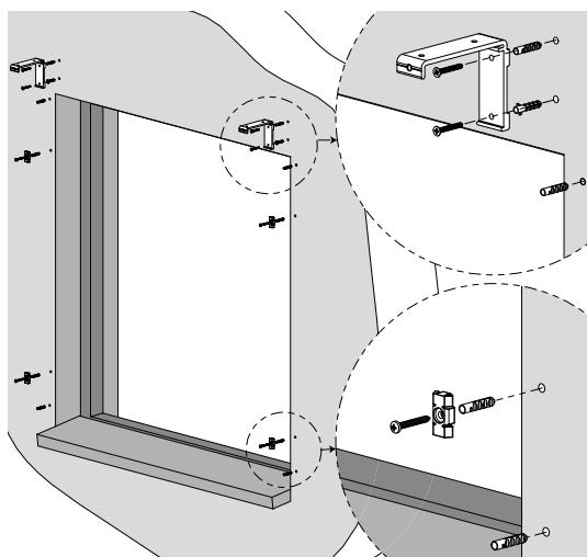
**Passo 1: Foratura per le travi di montaggio e le liste di guida**
