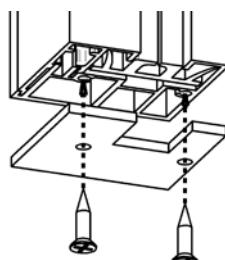
Se le liste di guida non stanno con il loro bordo al davanzale della finestra o sul pavimento, si devono usare i tappi terminali. Prima del passo seguente del montaggio, attaccare i tappi terminali con aiuto delle viti consegnate.
