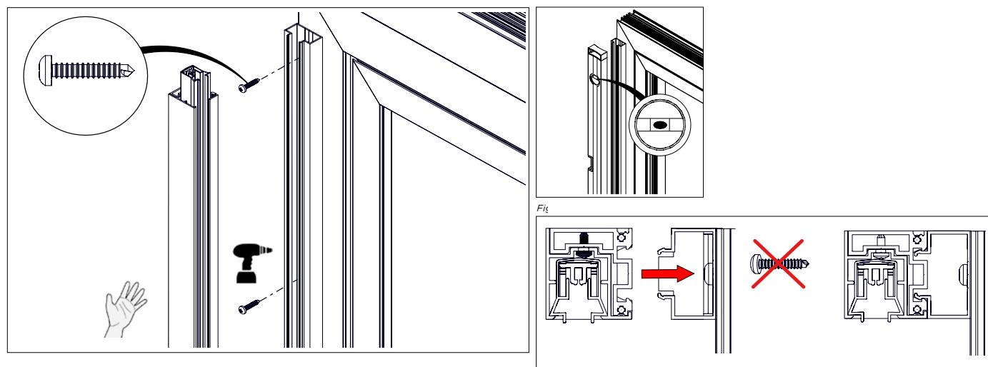
**!** Tenete in mente che nella parte inferiore del profilo click c'è un piccolo foro. Inserite in questo foro il terminale consegnato, tra la vite e il profilo. Tutto va fissato alla finestra.
