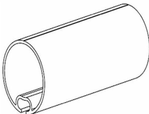
Materiale: alluminio estruso per tubi Ø 40, Ø 55 o Ø 67 mm e acciaio zincato per tubi Ø 85 e Ø 95 mm.
