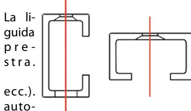
nea rossa segnata indica l'asse verticale per le viti di montaggio. Usare le liste di trapanate come sagoma per la trasposizione dei fori alla parete dell'anta della finestra. Avvitare le liste di guida alla parete con aiuto di viti e pezzi adeguati per il tipo della costruzione, alla quale si montano (costruzione di metallo, cemento, muratura, ecc.). Nel caso del montaggio frontale della lista di guida vengono consegnati i coperchi adesivi per coprire i fori delle viti di fissaggio.
