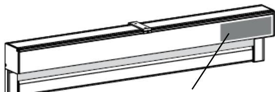
possibilità della sistemazione del pannello solare
