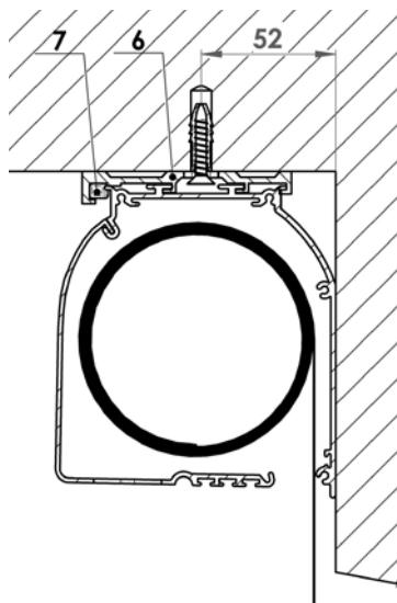
Montare le consolli (6) con aiuto di viti e pezzi adeguati per il tipo della costruzione alla quale si montano (costruzione di metallo, telaio della finestra o un altro materiale). Nei casi in cui si usano quattro consolli, garantire che le consolli siano perfettamente equilibrate  $\pm 1$  mm; ciò si può verificare, muovendo la cassetta lungo gli incavi prima di serrare le viti di fissaggio.
