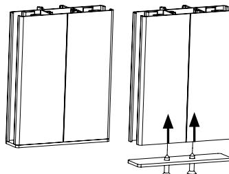
Con l'arresto finale di plastica nera o lamiera di alluminio nella parte inferiore per l'arresto della lista inferiore; spessore 2 mm.
