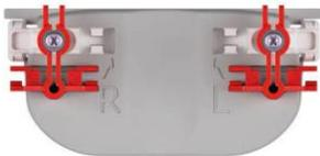
**3** Aprendo leggermente le clip, le viti si inseriscono saldamente nella guida e possono essere installate in questa posizione anche sopra la testa nella guida fermavetro superiore.
